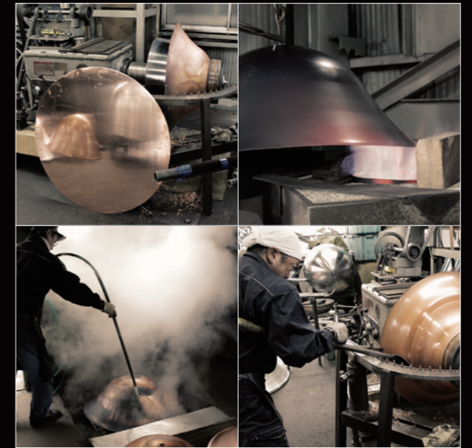
1枚のコパー板、あるいは、アルミ板に、熟練のクラフトマンがヘラを押し当てて、成形していく技術。ヘラのみで均一に仕上げられたケトルは、ヘラ絞りと熱処理を繰り返して、強度を増すことで、音感に優れ、サウンドの輪郭をはっきりと際立たせます。
